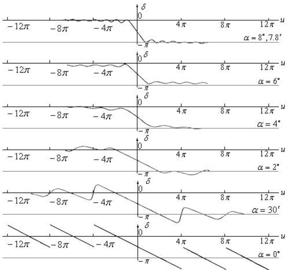
شکل ۵: رفتار «تابهنجاری - فاز» در طول باریکه هایی که از کانون عبور می کنند رسم شده است.  $\alpha$  زاویه ی شبب باریکه را نسبت به محور اپتیکی نشان می دهد [4,6]. این شکل به ازای  $\lambda = 5 \times 10^{-5} \text{ cm}$ ,  $a = 2.5 \text{ cm}$ ,  $f = 10 \text{ cm}$  رسم شده است.
