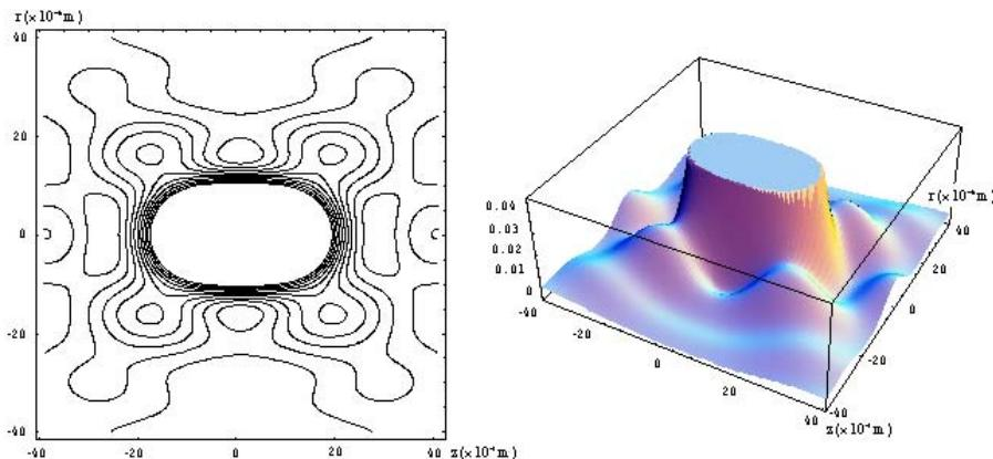
شکل ۳: شکل سمت چپ پربند های شدت ثابت را نشان می دهد برای اینکه درک به تری از اندازه ی شدت داشته باشد، اندازه ی آن را برای همین حالت در سمت راست رسم کرده ایم (این محاسبه ها به طور عددی و به وسیله ی نرم افزار Mathematica انجام شده است)، این شکل ها به ازای  $\lambda = 5.14 \times 10^{-5} \text{ cm}$ ,  $a = 0.1 \text{ cm}$ ,  $f = 5.2 \text{ cm}$  رسم شده اند.
