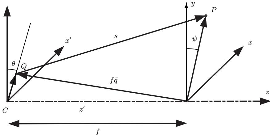
شکل ۲:  $z$  محور - اپتیکی،  $xyz$  صفحه ی تصویر و  $x'y'z'$  صفحه ی روزنه هستند [4].
