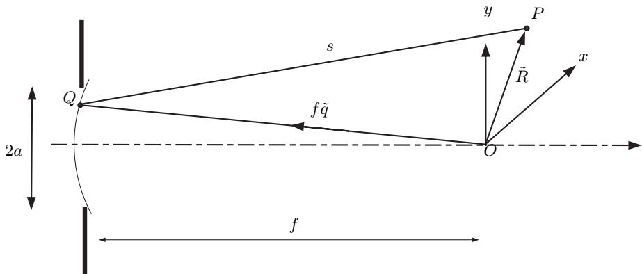
شکل ۱: نمای موج پراشیده شده از روزنی ی دایره ای در شکل بالا نشان داده شده،  $Q$  نقطه ای روی جبهه ی موج،  $P$  نقطه ی مشاهده و  $O$  کانون است.
